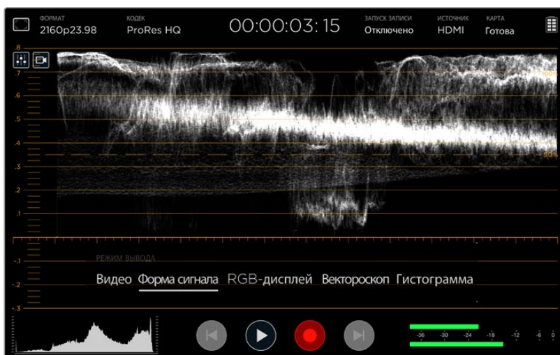
Дисплей формы сигнала показывает уровни яркости
