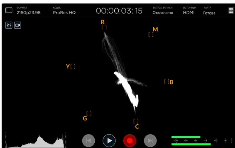
Вектороскоп позволяет оценить диапазон оттенков цвета и насыщенность изображения
