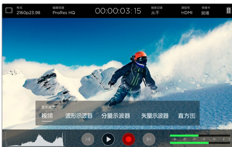
图为视频示波器菜单栏，当中提供了不同的示波器显示选项
