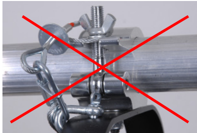
Bild 5: Schlaufe nicht an Ringmutter verhaken
