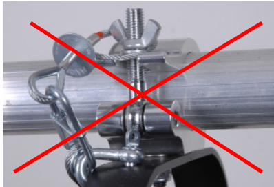
Bild 5: Schlaufe nicht an Ringmutter verhaken
