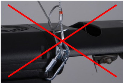
Bild 4: Sicherungsseil nicht durch Schlaufe führen.
