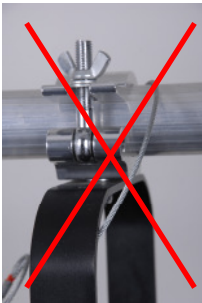
Bild 1: Sicherungsseil nicht über scharfe Kanten führen.
