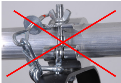
Bild 5: Schlaufe nicht an Ringmutter verhaken
