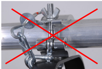
Bild 5: Schlaufe nicht an Ringmutter verhaken
