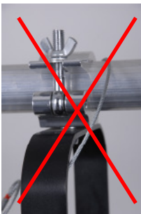
Bild 1: Sicherungsseil nicht über scharfe Kanten führen.
