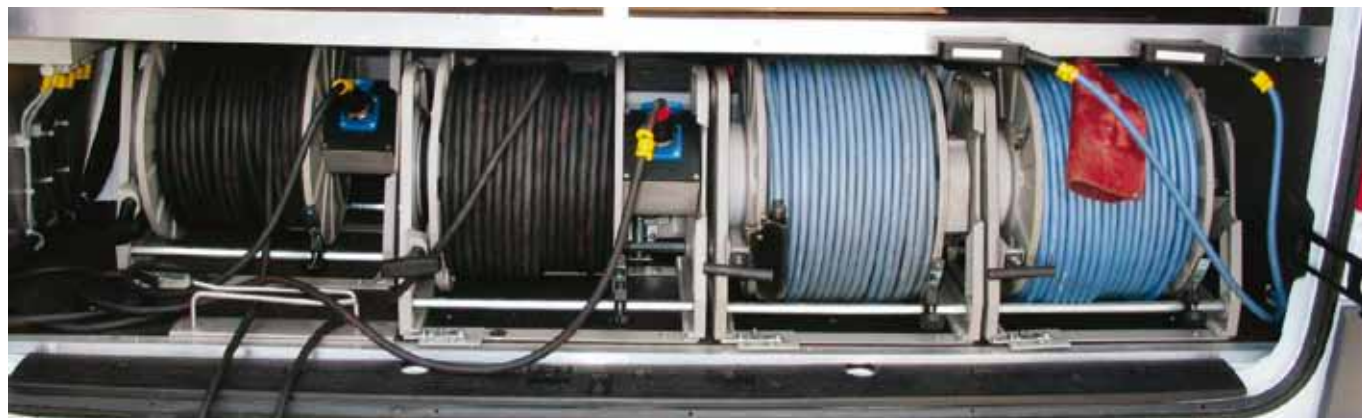
ALD-Modelle auf Einbauschinen montiert_ALD models mounted on installation rails
